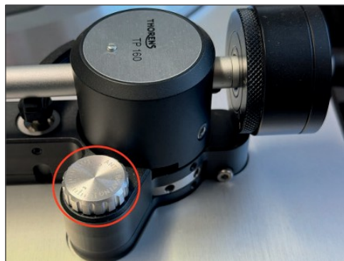
Obr. 9 Nastavovací kolečko pro anti-skating
