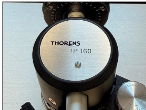
Obr. 8 Nainstalované protizávaží se stupnicí pro přitlačnou sílu (hodnota 2) a nastavovacím kolečkem pro magnetický antikating.
