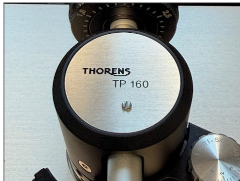
Obr. 8 Nainstalované protizávaží se stupnicí pro sledovací sílu (hodnota 2) a nastavovacím kolečkem pro magnetické protiskluzové zařízení.
