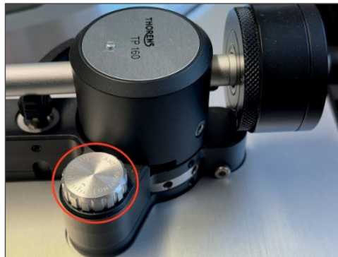
Obr. 9 Nastavovací kolečko pro antikating
