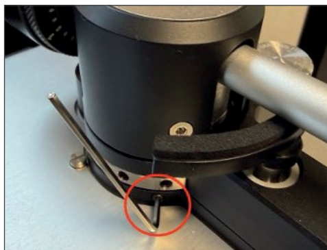
Obr. 12 Poloha vnitřního zajišťovacího šroubu
