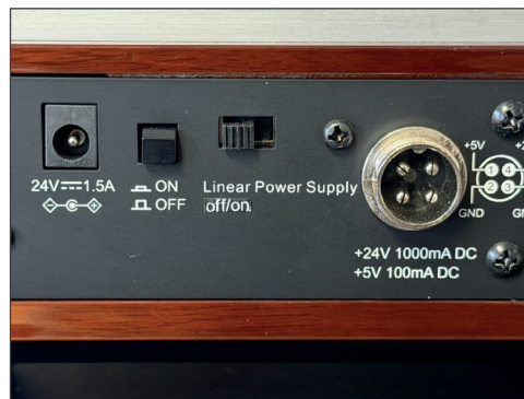
Obr. 20 Připojovací svorkovnice napájení.
