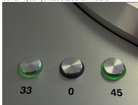
Obr. 22 Zapnutá rychlost 78 otáček za minutu.
