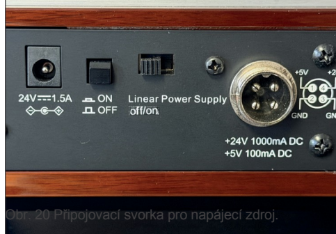
Obr. 19 Přepínač napětí na lineárním napájecím zdroji TPN 124.
