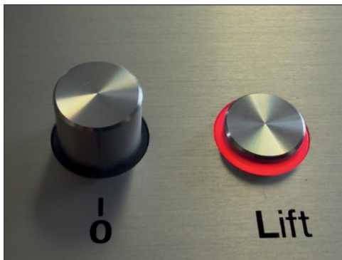
Obr. 23 Fotografie tlačítka pro zvednutí raménka během přehrávání.
